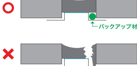
目地幅が拡大している場合は、隙間をバックアップ材などで埋め、二面接着を確保する必要があります。
