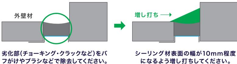
**注意** 異種シーリング材による増し打ちの場合は、後打ちするシーリング材の専用プライマーを塗布してから施工してください。
