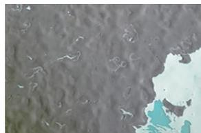
造膜途中の降雨による剥離
