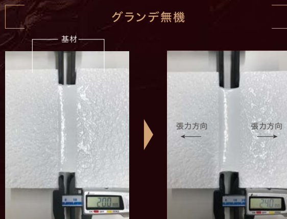
グランデ無機は4.0mm伸長してもなおひび割れは生じませんでした。
