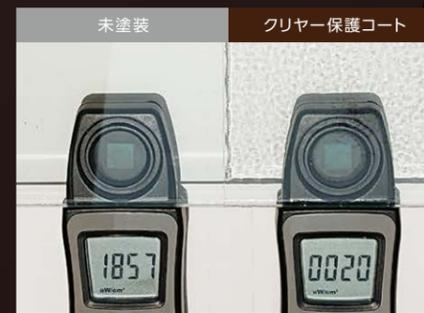
ガラス面右半分にクリアー保護コートを塗布し、屋外で紫外線強度を測定した結果、塗布していない左面に比べ、高い紫外線透過抑制効果を発揮していることが確認できます。
