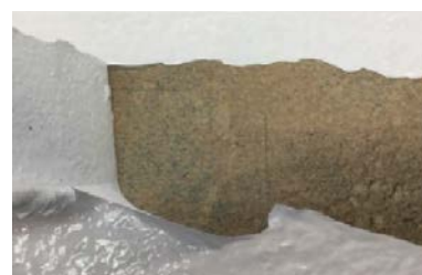
光セラに施工した塗膜
